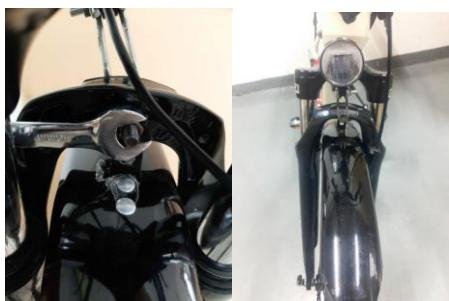
Schritt 2: Entfernen Sie das Rad vom E-Bike und befestigen Sie es an der Vordergabel mit dem Schnellspannhebel. Achten Sie darauf, dass die Scheibenbremse nicht scheuert.
