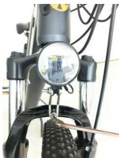
Schritt 2: Entfernen Sie das Rad vom E-Bike und befestigen Sie es an der Vordergabel mit dem Schnellspannhebel. Achten Sie darauf, dass die Scheibenbremse nicht scheuert.
