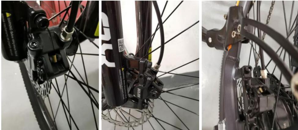
Die Bremse ist eine hydraulische Scheibenbremse. Die Scheibe muss sich in der Mitte der Bremse befinden, um sicherzustellen, dass die Scheibenbremse nicht an der Scheibe scheuert.
