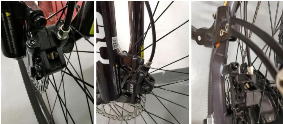
Die Bremse ist eine hydraulische Scheibenbremse. Die Scheibe muss sich in der Mitte der Bremse befinden, um sicherzustellen, dass die Scheibenbremse nicht an der Scheibe scheuert.
