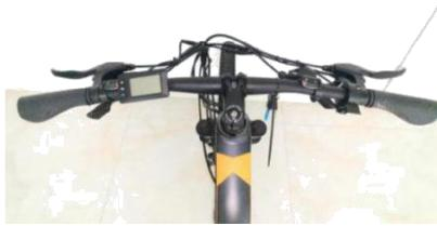
(Die Gangschaltung ist auf der rechten Seite des Lenkers und das Display auf der linken Seite. Der Winkel des Lenkers kann verstellt werden.)
