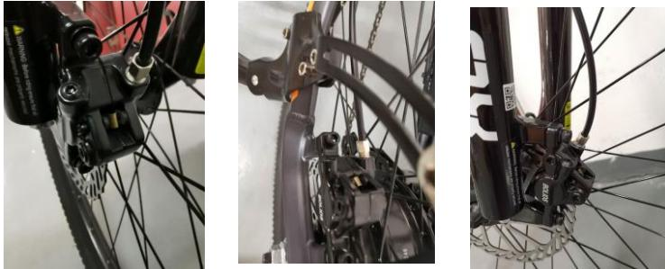
Die Bremse ist eine hydraulische Scheibenbremse. Die Scheibe muss sich in der Mitte der Bremse befinden, um sicherzustellen, dass die Scheibenbremse nicht an der Scheibe scheuert.
