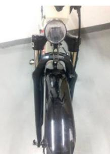
Schritt 2: Entfernen Sie das Rad vom E-Bike und befestigen Sie es an der Vordergabel mit dem Schnellspannhebel. Achten Sie darauf, dass die Scheibenbremse nicht scheuert.
