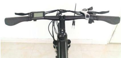
(Die Gangschaltung ist auf der rechten Seite des Lenkers und das Display auf der linken Seite. Der Winkel des Lenkers kann verstellt werden.)
