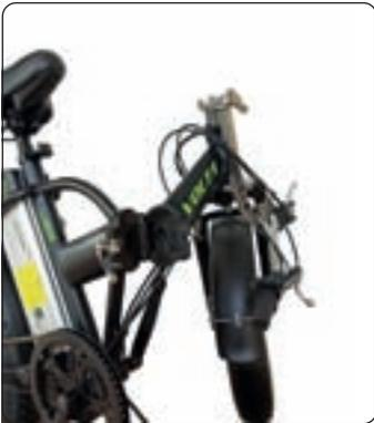
3- Bereiten Sie Ihr Fahrzeug und den Lenker für das Zusammenklappen vor, während die Klappvorrichtung und die Lenkerklappvorrichtung Ihres Fahrzeugs geöffnet sind.
