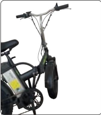
1- Befestigen Sie zunächst Ihr Fahrzeug am Fahrradfuß und öffnen Sie den Klappapparat. Dann machen Sie Ihr Fahrzeug bereit, um nach links zu klappen.
