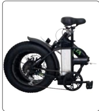
4- Klappen Sie Ihr Fahrzeug, indem Sie den Lenker nach unten und den Teil des Klappapparats in Richtung Hinterreifen drücken
