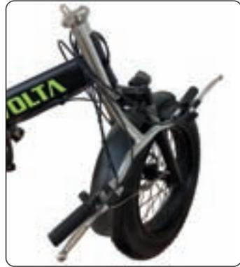
2- Öffnen Sie die Klappvorrichtung unten am Lenker und klappen Sie den Lenker bis zum Vorderreifen herunter.
