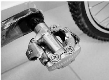
**WARNUNG:** Prüfen Sie die korrekte Klemmung der Pedale. Befolgen Sie sorgfältig die Anweisungen, um Beschädigungen an den Pedal- oder Kurbelgewinden zu vermeiden, und prüfen Sie die Abnutzung der Stiftschrauben.
